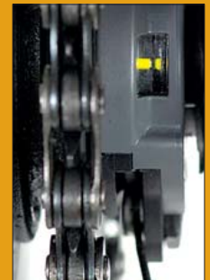
Das Fenster zeigt die Zuglängen-Markierungen bei Shimano und SRAM.
