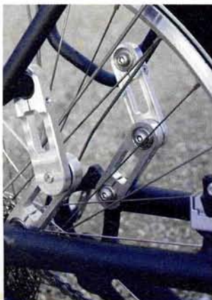
Seitliche Führung der Packtaschenhalter beim Intercontinental von Riese und Müller
