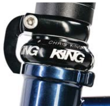
Der teil-integrierte Lenkeranschlag schützt effektiv vor Schäden am Rahmen
