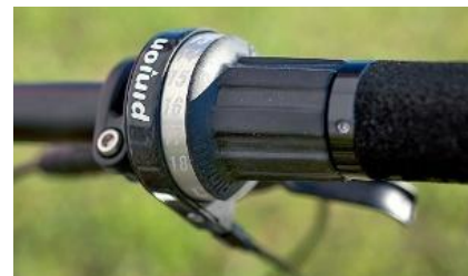
Ein Rastschalter mit Pull-Pull-Zügen verteilt die 18 Getriebegänge auf eine Griff-Umdrehung.
