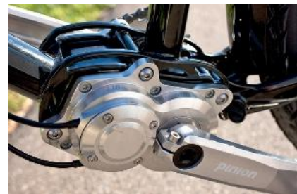
Extrem kompakt und mit idealem Schwerpunkt hängt die Pinion-Box an einer speziellen Rahmenaufnahme.
