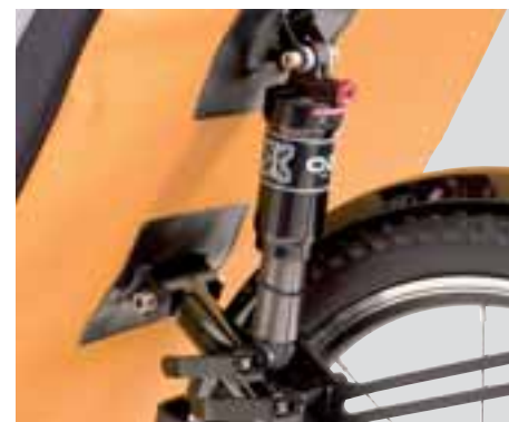
Aktive Fahrsicherheit: Der Luftdämpfer am Tout Terrain bietet bis zu 200 mm Federweg und ist leicht auf das Kindergewicht einzustellen. Ein optionales Schutzblech beschirmt ihn vor Dreck.
