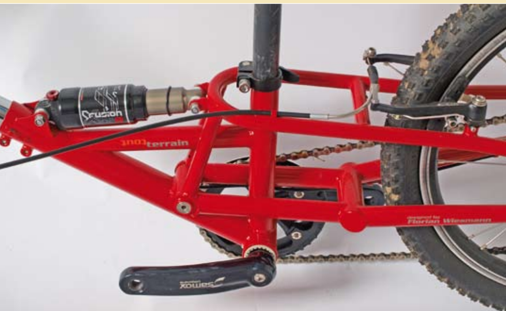
Hinterradfederung (Eingelenkerprinzip) mit 160- oder 200-mm-Federweg.
