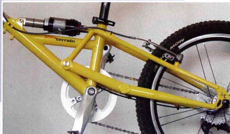
So werden 200 mm Federweg realisiert.
