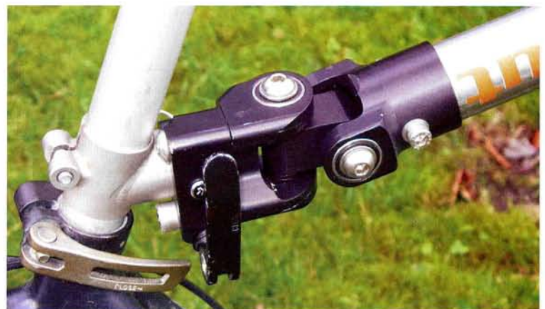
Die Kupplung mit Kardangelen im Detail
