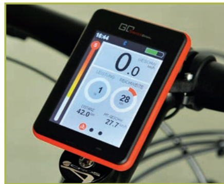
Überraschung: Das Display präsentiert sich farbig. Die Leistungsangabe in Watt (linker Kreis hilft beim Stromsparen).
