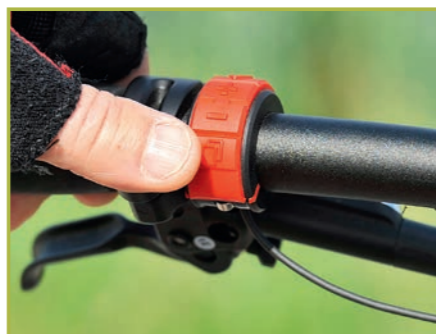
Am Griff links: Der Bedienring des Displays, seine Tasten könnten erhabener sein.
