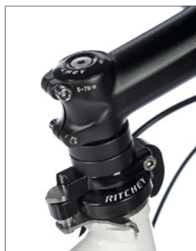
Standfest: Zusätzlich zum Lenkeranschlag arretiert ein Mechanismus Lenker und Vorderrad beim Parken.
