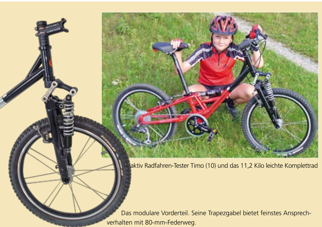
Hinterradfederung (Eingelenkerprinzip) mit 160- oder 200-mm-Federweg.
