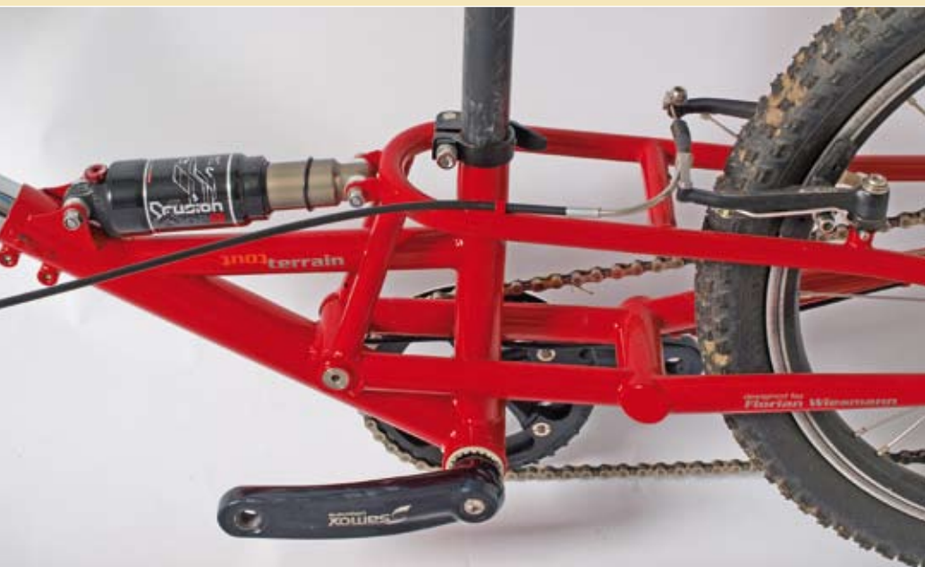
Hinterradfederung (Eingelenkerprinzip) mit 160- oder 200-mm-Federweg.
